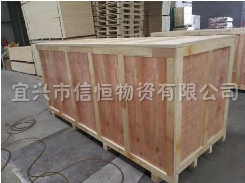
普通木包装箱它由侧面，端面，底及盖构成。先将端面装在侧面上，然后将底和盖装在侧面与端面上而成。主要用于机械产品的包装，也可用于小件货物的集装。普通木包装箱主要以端面和侧面为基础来承载，它比普通木箱能承受更大的载荷。因此适合作为中型产品的外包装用木箱。木包装箱在出口的时候必须是经过国家检验检疫机构认证的包装木箱，不能有任何虫卵和污染物才能达到出口要求，出口木包装箱的出现为提高我国的对外贸易起到了极大的推动作用，这种方式不仅能保证货物的质量，同时还能减少损失。出口木箱定制价格木箱包装环保程度高。
